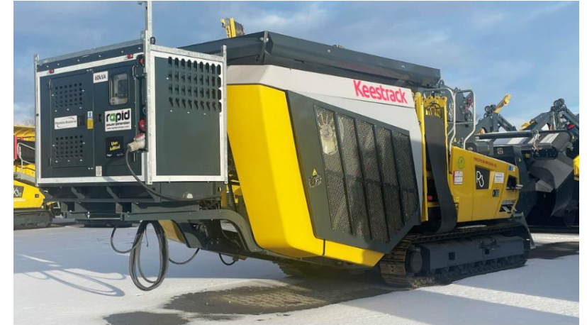
GJENVINNING PÅ STRØM: Dette knusverket fra Keestrack er beregnet på gjenvinning og kan fås med eller uten motorpakke. Fredheim Maskin
