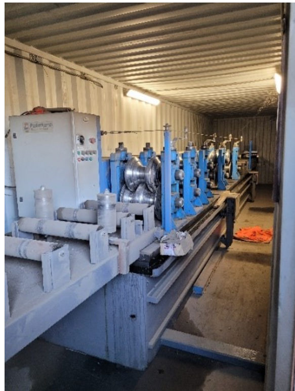
Figur 2 Etter visuell inspeksjon sendes rekkverkskinnene gjennom en formrulle.
