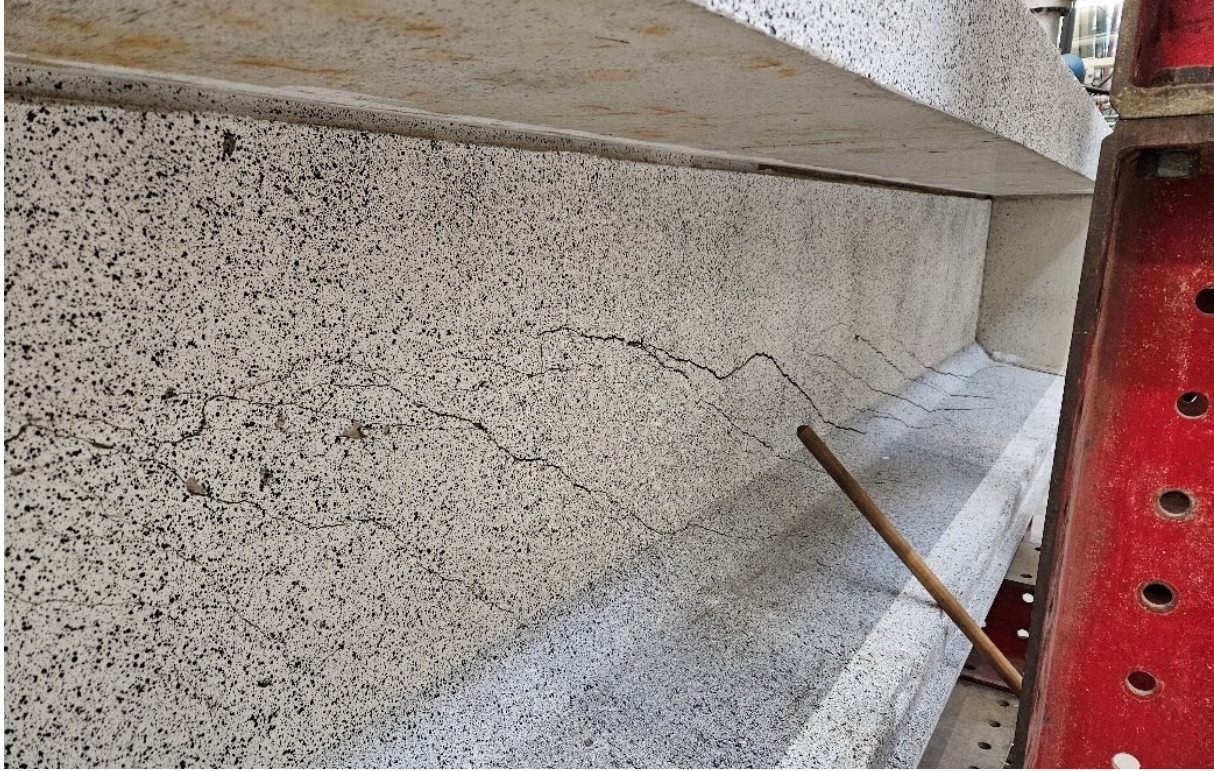
Figur 20 Måling av skjærkapasitet i betongbjelker.
