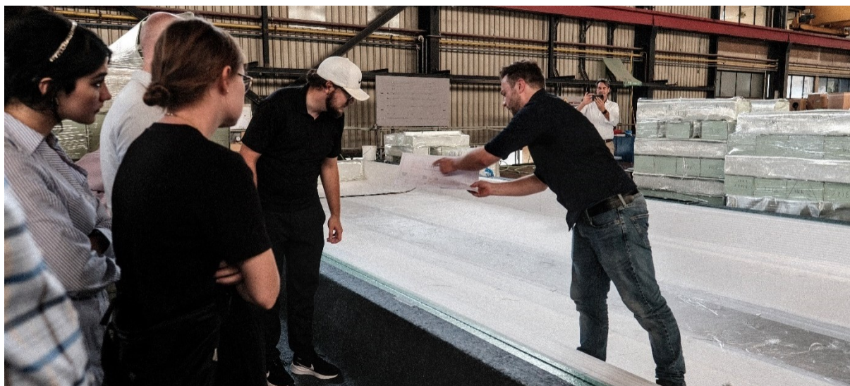
Figur 12 Formen til brua bygges opp av skumkjerne og glassfiber før den støpes ut med harpiks.
