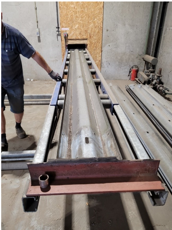
Figur 1 Prosessen starter med visuell inspeksjon av rekkverkskomponentene og eventuell oppretting ved bruk av hammer.
