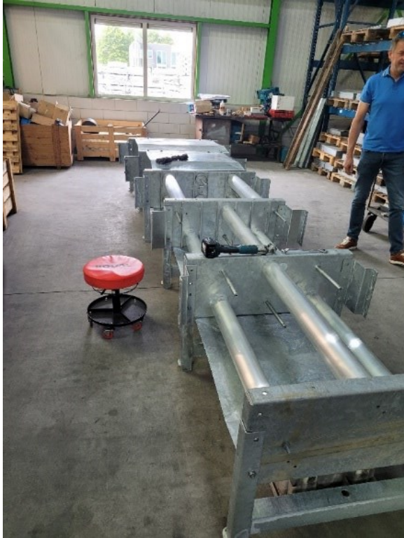
Figur 5 Støtpute som holder på å monteres.
