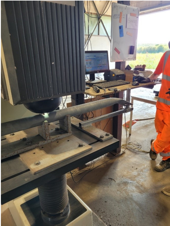
Figur 3 Rekkverkskomponentene går gjennom en Brinell test ett sted på komponenten. Deretter måles galvaniseringstykkelsen også et sted. Komponenter med for liten galvaniseringstykkelse sendes til degalvanisering og regalvanisering som utføres av en annen fabrikk.
