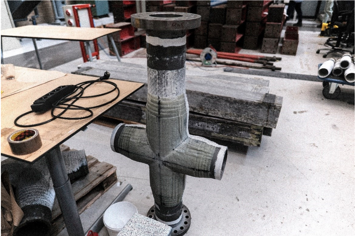
Figur 24 Stålrør knyttet sammen med stoff i kunstfiber.
