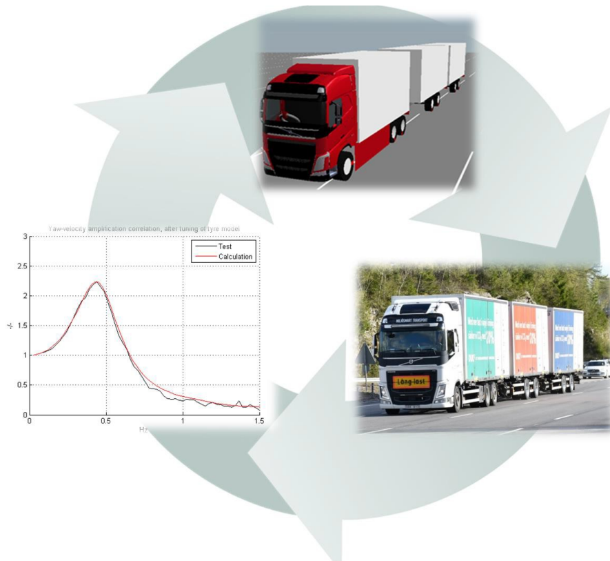
Figur 8: Validering och justering av beräkningsmodell med hjälp av prov med C-dubbel
