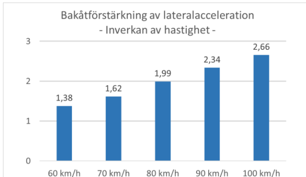
Figur 32: Vänster: Bakåtförstärkning av lateralacceleration (Inverkan av hastighet) Höger: Lastöverföring vid undanmanöver (Inverkan av hastighet)
