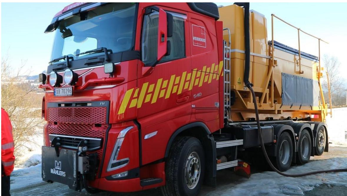
Figur 6. Det varme vannet fra den eksterne kilden blir fyldt på tank på strøbilen. (Foto: Veidekke)
