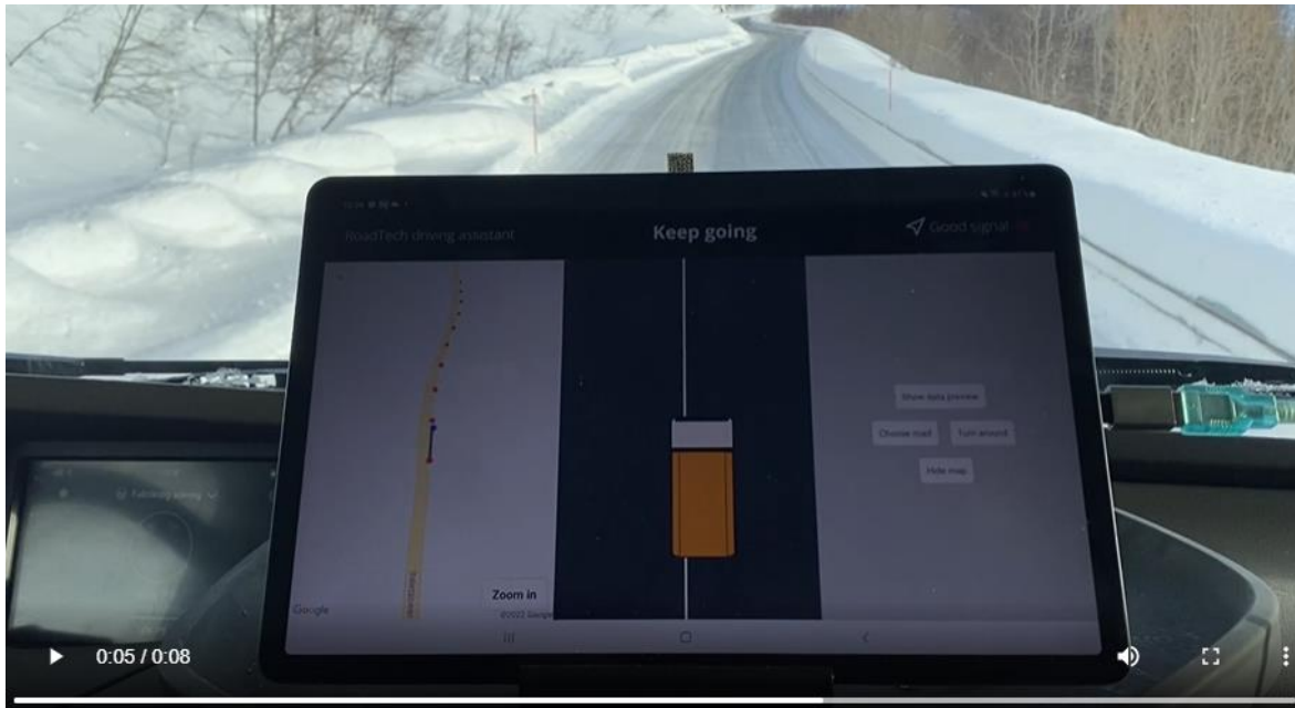
Figur 7. Den digitale brøyteassistenten viser sjåføren hvor vegen går. Foto: Lena Brox, Statens vegvesen.
