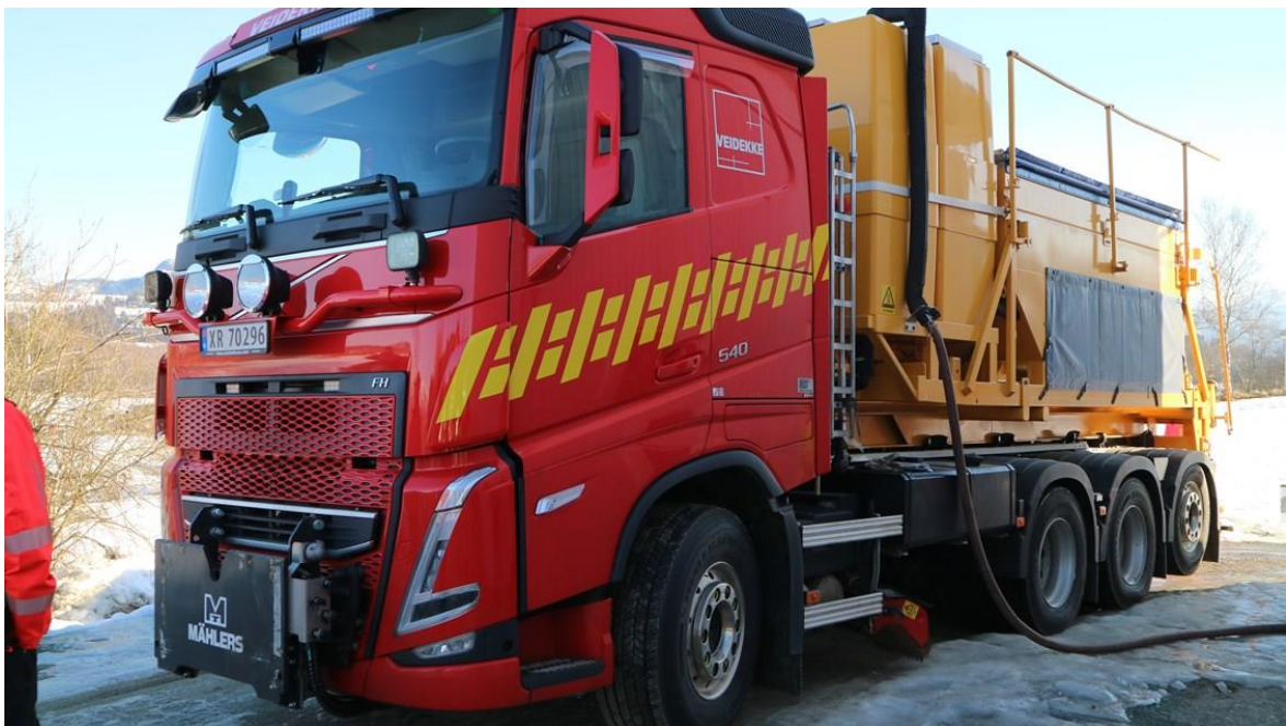
Figur 6. Det varme vannet fra den eksterne kilden blir fylt på tank på strø bilen. (Foto: Veidekke)
