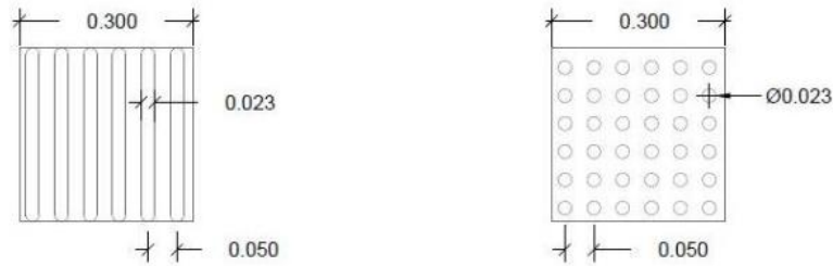
Mynd 4-13 Hellur ætlaðar til að mynda sértækar leiðarlínur, vinstra megin er stefnueining og áherslu- og varúðareining hægra megin (Mynd: Áslaug Katrín Aðalsteinsdóttir).
