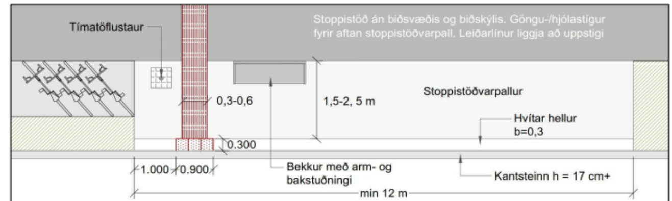
Mynd 5-5 Mynd sýnir notkun á leiðarlínunni við stoppstöð án biðskýlis og sérstaks biðsvæðis. Göngu- og hjólastígur liggur utan við stoppstöðvarpall. Leiðarlínur fanga væntanlega farþega frá göngustíg og leiða þá að uppstigi í vagn. Hjólagrindur eru staðsettar utan við stoppstöðvarpall, fjær akstursstefnu (Mynd: Áslaug Katrín Aðalsteinsdóttir).
