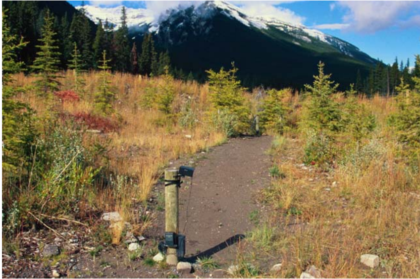
Fig. 28: Sporingsgrop på viltovergangen “Wolverine Pass”, H1. Stolper med fotoceller, kamera og teller.
