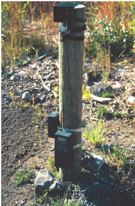
Fig. 29: Viltovergangen “Wolverine Pass” med fotocelle, kamera og teller.
