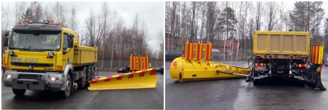
I Finland har Destia haft projekt för att ha plogging med bättre kvalitet och hastighet. Större plogninsdbred med sidoplog har varit i praktik nästan 4 vintern. För 2-fältsväg med över 3-4 meter snörymme i mitten kan plogas med prototyp sidoplog för vänster sidan. Plogbil med sidoplog för vänster och höger sidan har större effektivitet i varierande snöförhåll.
