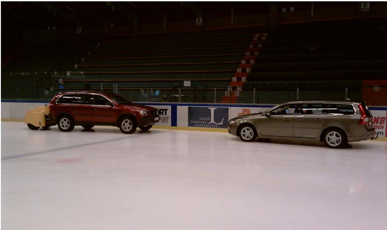
Under accelerations och bromstesten inne i ishallen uppmättes stabila väggreppsvärden och statistiskt signifikanta skillnader mellan olika vinterdäck. Mätningarna av temperaturen i och på isen varierar ytterst lite under testen, anläggningen kan programmeras för olika is temperaturer och luftfuktighet.
