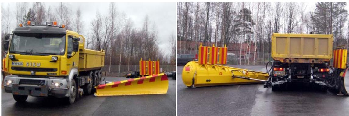
I Finland har Destia haft projekt för att ha plogning med bättre kvalitet och hastighet. Större plogningsbredd med sidoplog har varit i praktik nästan 4 vintern. För 2-fältsväg med över 3-4 meter snörymme i mitten kan plogas med prototyp sidoplog för vänster sidan. Plogbil med sidoplog för vänster och höger sidan har större effektivitet i varierande snöförhåll.
