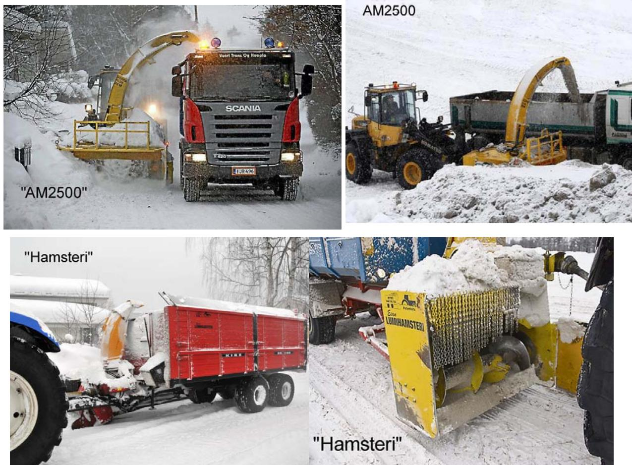
Snöslunga för att lasta snö. Belastningstid 1-2 minuter. Arctic Machine AM2500
