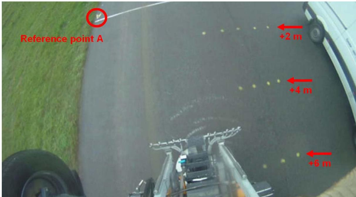
Figur: En enkelt video-frame fra kameraet monteret på toppen af sprederen. Her ses referencelinjen samt de tre første 2-meter markeringer tydeligt sammen med den første salt, der netop når +4 meter.
