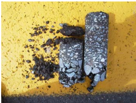
Figur 22 Gardermøens gamle dekke gikk fullstendig i oppløsning
