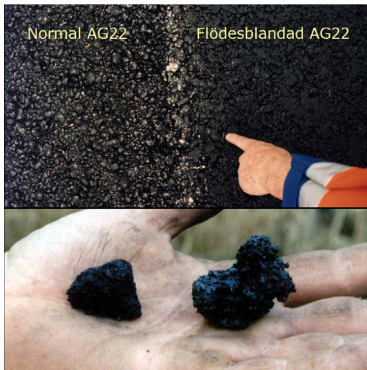
Bild 1 och 2: Okulära effekter. Till vänster ses AG22 160/220 4.2% och höger samma massasort med KGO-III metoden. Handen på bilden under har stenar från väggkant plockats från respektive massa. Det syns tydligt att KGO-tillverkad massa har mer "bruk" på stenarna.
