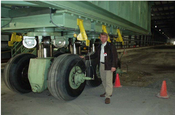
Figur 7 Hjulunderstell til B777 og ingeniør
