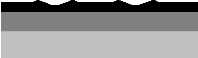
Figur 3. Permanenta deformationer i asfaltbeläggning.
