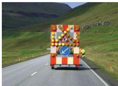
Skiltevoan anvendes ved mindre arbejder såsom reparationer af belægninger
