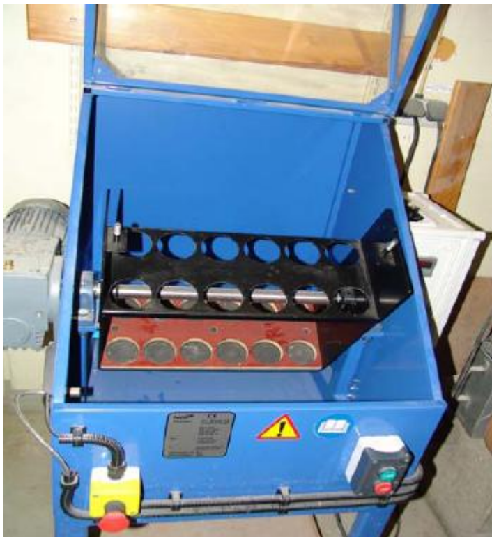
Figur 3: Udstyr til rotation af 12 cylindre samtidig
