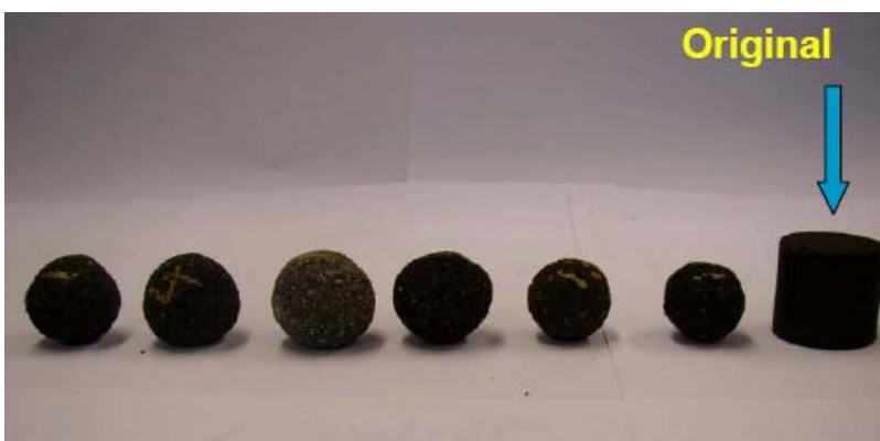
Figur 4: Eksempler på prøvelegemer efter test sammenholdt med originale prøvelegeme
