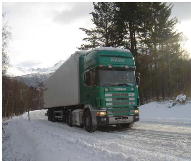
**Figur:** Bil 3. Semi med enkel aksling og 3-aksla tralle.
