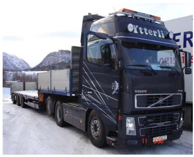
**Figur:** Bil 2. Semi med boggi med 3-aksla tralle.
