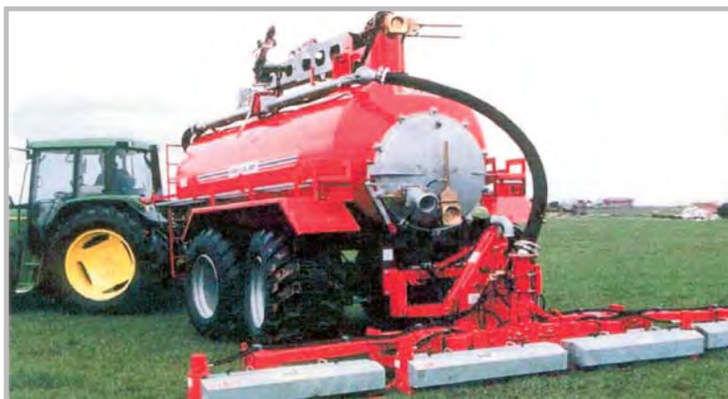
Gjødselsvogn fra Moi AS hvor gjødsla presses ned i jorda (DGI)
