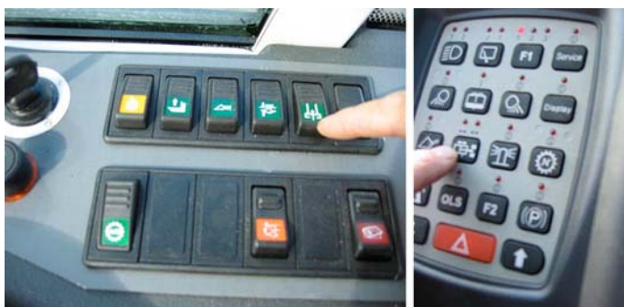
Bilde nr. 17 :O&K instrumentpaneler med brytere for betjening av HK-feste på hjullastere 10 – 23 tonn.
