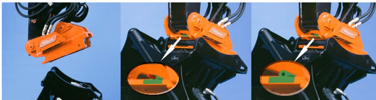
Bilde nr. 2 Hurtigkobling av «S» typen – OQ 45. Posisjoner ved montering av skuffe / redskap.
