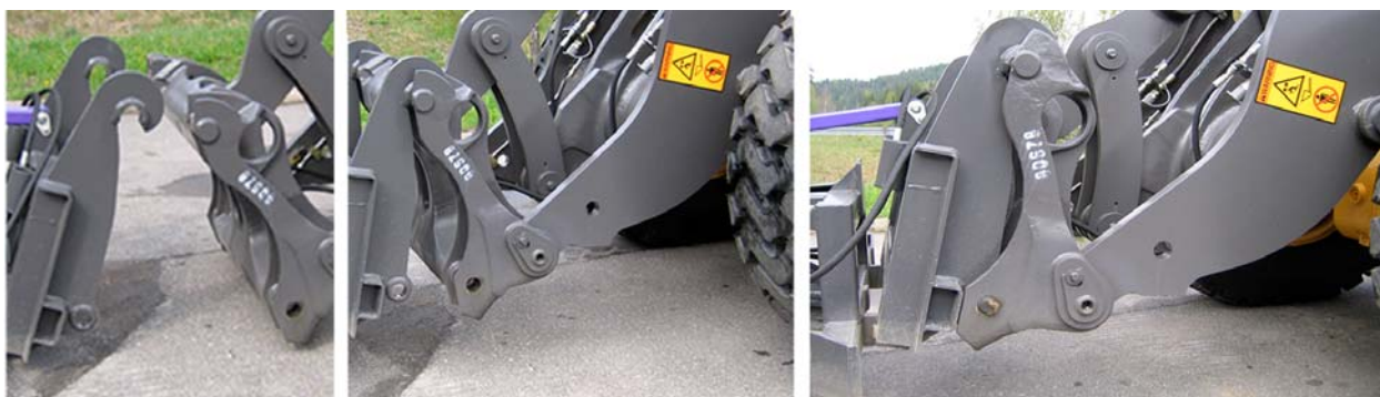
Bilde nr. 3 VOLVO hurtigkobling i de forskjellige posisjoner
