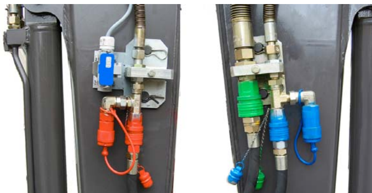
Bilde nr. 14 VOLVO kompaktgraver med fargekoding
