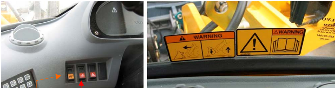
Bilde nr. 16 VOLVO L 120 E 2003 mod. Bryterpanel for betjening av HK-feste med visuelt advarselskilt for riktig betjening og sikkerhet på hjullastere 6 → 50 tonn
