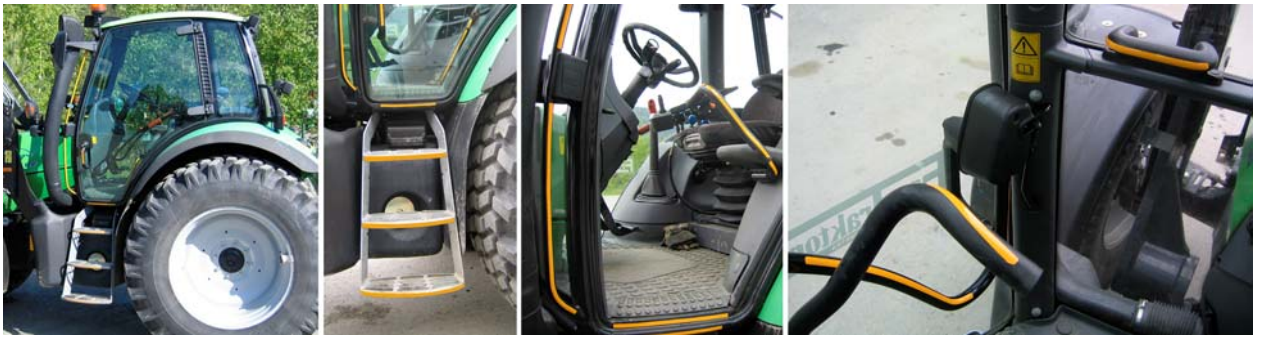
Bilde Nr 21 Varselmerking med gul farge på stigtrinn og håndtak, gule striper på grå, eller svart bakgrunn.
