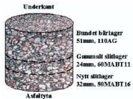
Figur 1 Provkropparna bestod av tre asfaltlager. Observera att asfaltytan är nederst.
